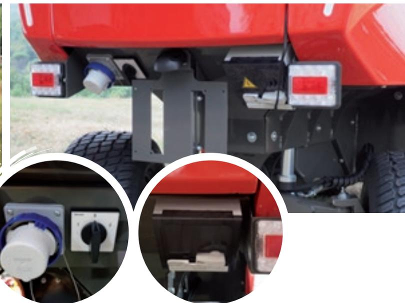
**RINO®** eroga una potenza reale di 18 kW (24cv) alimentando due motori elettrici di uguale potenza, per la motricità e per il lavoro dell'accessorio. Può inoltre animare numerose altre attrezzature "affamate" di potenza come biotrituratore, turbina neve, tagliaerba elicoidale.
