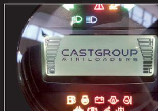
Display elettronico con spie anomalie, luci, motore, livelli olio idraulico e sistema elettrico flottaggio.
