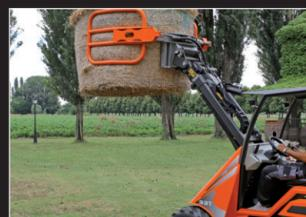
Hauteur du bras télescopique de 2950 mm, c'est la plus haute de la catégorie et est de série sur tous les modèles.
