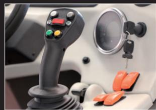
Standardmäßiges 4,6-fach Joystick. 10-fach Joystick ist Standard bei LX.
