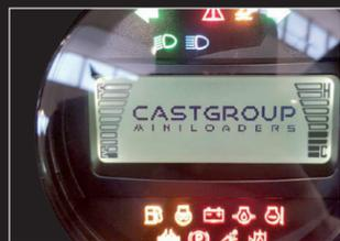
Elektronisches Display mit Warnleuchten zur Angabe von Anomalien, Motor, Hydraulikölstand und elektrischem Hubarm Schwimmstellung.
