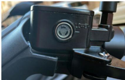
Con lo scooter sul cavalletto centrale su una superficie piana, ruotare il manubrio fino a quando la pompa del freno, il cui livello deve essere controllato, è orizzontale. Attraverso la spia del serbatoio della pompa, verificare che il livello del liquido dei freni sia al di sopra del segno "LOWER".
