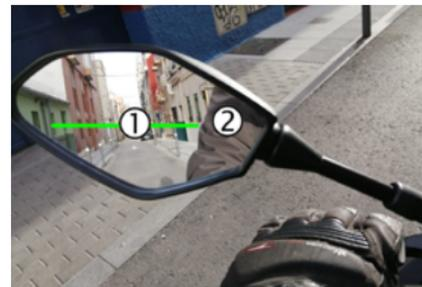
Orientare lo specchio in modo che la linea dell'orizzonte (1) sia al centro della superficie e che una parte del braccio dell'utente (2) appaia nell'angolo interno dello specchio e serva da riferimento per individuare oggetti o veicoli alle spalle dell'utente. Fare lo stesso con l'altro specchio retrovisore.
