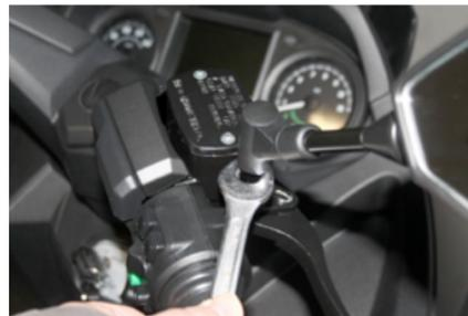
Allentare il controdado alla base del montante degli specchietti con una chiave inglese aperta da 14 mm e orientare il montante con il manubrio dritto in modo che sia perpendicolare all'asse longitudinale del veicolo (non parallelo al manubrio) per ottenere il punto più lontano dagli specchietti.
