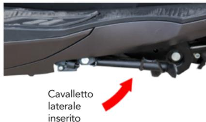
Lo scooter è dotato di un cavalletto laterale accessibile dal lato sinistro del veicolo. Il cavalletto laterale è dotato di un interruttore di accensione. Se il cavalletto è esteso, lo scooter passa in modalità PARKING (il motore non funziona in questa modalità)
