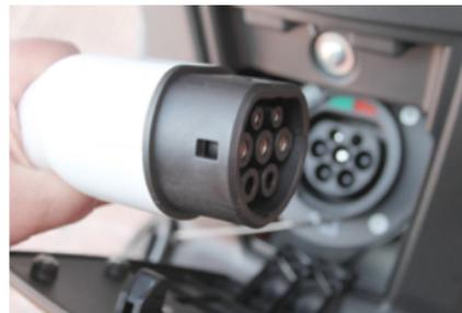
La batteria della moto viene caricata collegandola direttamente alla rete elettrica. A tale scopo, la moto è dotata di un collegamento di tipo 2.
