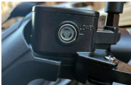
Avec le scooter sur sa béquille centrale sur une surface plane, tournez le guidon jusqu'à ce que la pompe de freins, dont vous allez vérifier le niveau, soit horizontale. À travers le judas du réservoir de la pompe, vérifiez que le niveau de liquide de frein est supérieur à la marque « LOWER ».
