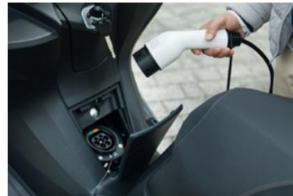
2. Raccordez l'autre extrémité du câble de recharge à une prise domestique du réseau électrique avec prise de terre.
