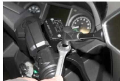
Desserrez le contre-écrou de la base du support du rétroviseur à l'aide d'une clé plate de 14 mm et orientez le support en maintenant le guidon droit de manière à ce qu'il soit perpendiculaire à l'axe longitudinal du véhicule (pas parallèle au guidon) afin d'obtenir le point le plus éloigné des rétroviseurs.
