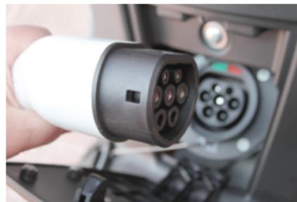
La batterie de la moto est chargée en branchant directement au réseau électrique. Pour ce faire, la moto possède une connexion de type 2. Le véhicule peut être chargé sur n'importe quelle prise domestique du réseau électrique alternatif de 220 V 50 Hz grâce à un câble de connexion fourni d'origine avec le scooter.
