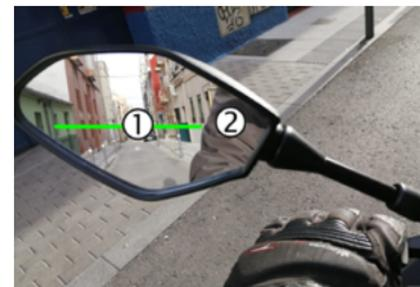
Orientez le rétroviseur de sorte que la ligne d'horizon (1) se trouve au centre de la surface et que dans le coin intérieur du rétroviseur une partie du bras de l'utilisateur apparaisse (2) et nous serve de référence pour placer les objets ou véhicules derrière nous. Faites de même avec l'autre rétroviseur.
